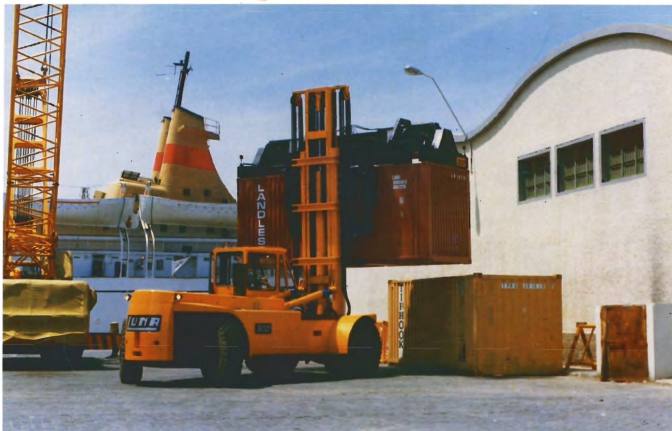
Carretilla elevadora de contenedores, 32 toneladas de carga
